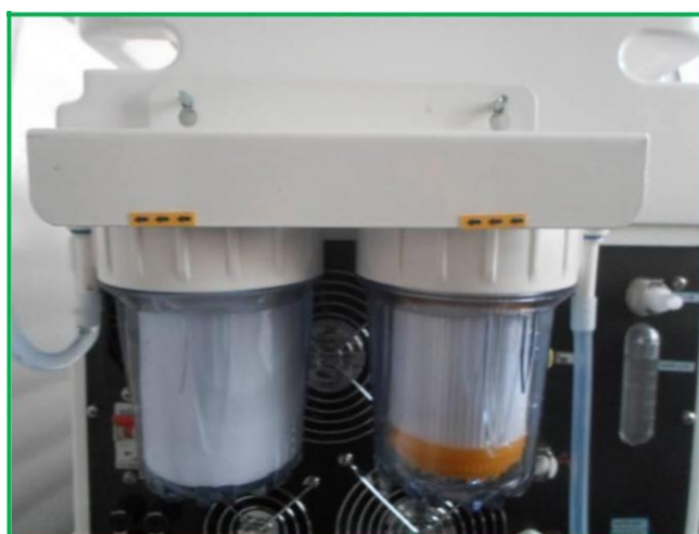
Рис 6-4 Установка фильтра на стопорный винт
