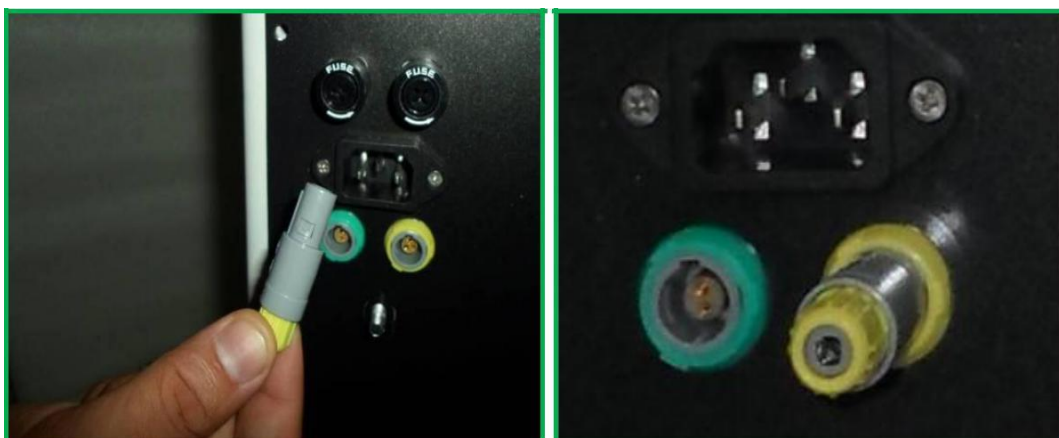
Рис 6-8 Установите перемычку блокировки переключателя
